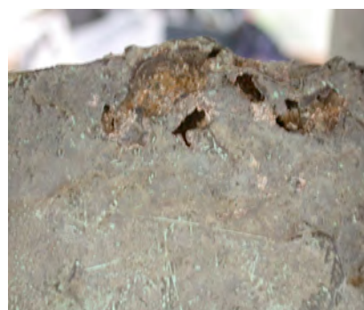
Photos 9 et 10: Fehler im Guss, Blasen und fehlendes Material, Löcher und Krater.
