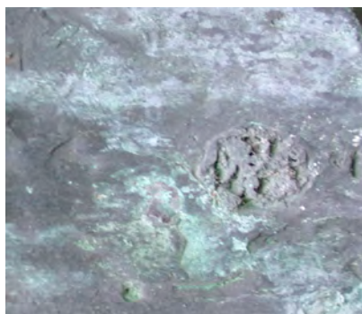
Photos 9 et 10: Fehler im Guss, Blasen und fehlendes Material, Löcher und Krater.
