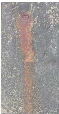
Photos 17, 18, 19 et 20: Eisenstab vor der Behandlung, nach der Bohrung, eingefügter und geschmiedeter Kupferstab, weniger deutliche Fließspuren nach der Sandstrahlung
