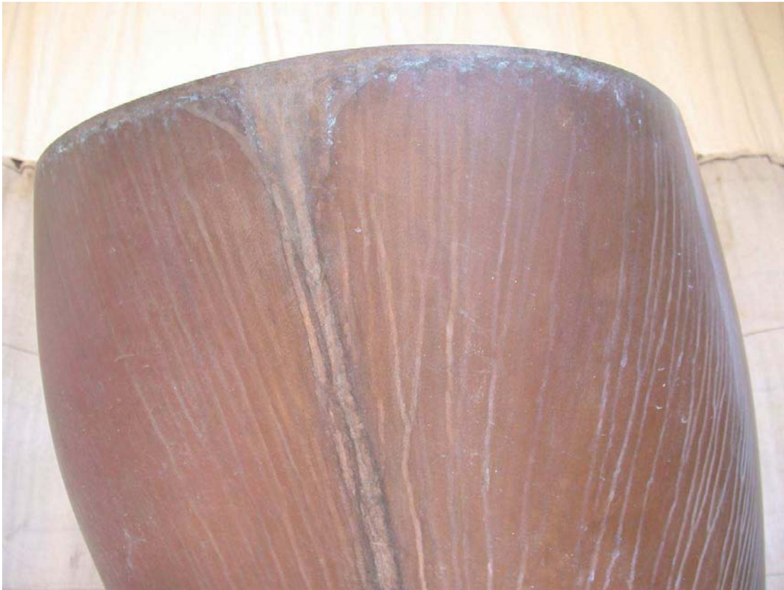
Figure 5: Laufspur mit organischen Auflagerungen und Korrosion.
