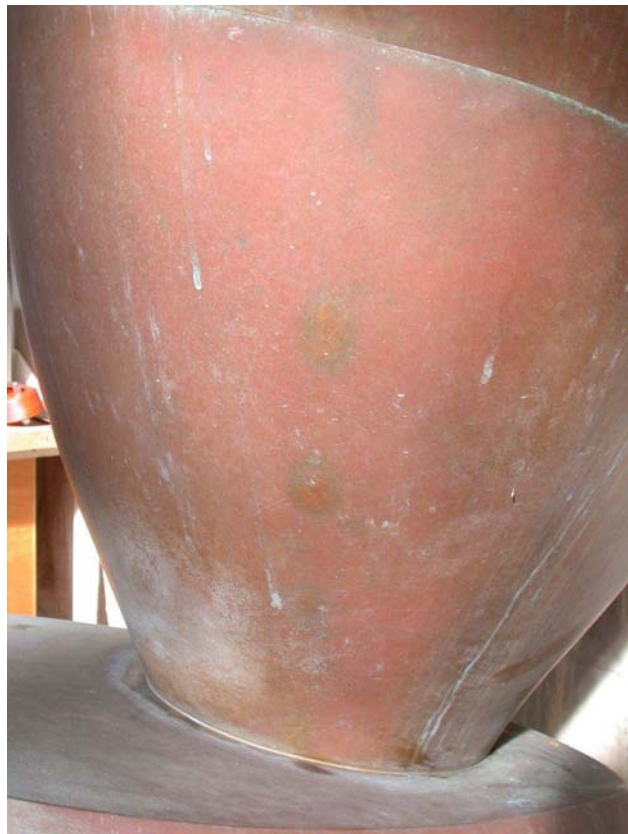
Figure 12: Fehlstellen in der Oberfläche der mittleren Schale.
