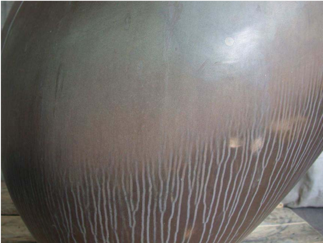
Figure 11: Grenze zwischen ab gewitterter Patina und originaler Patina mit Laufspuren.
